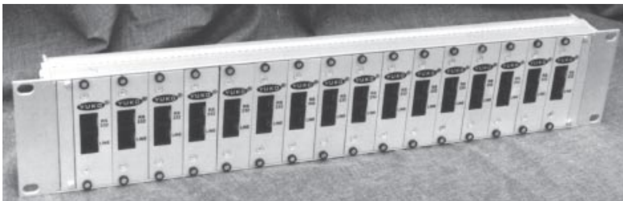
Rys 5. Kasetka z modemami ASM-5
